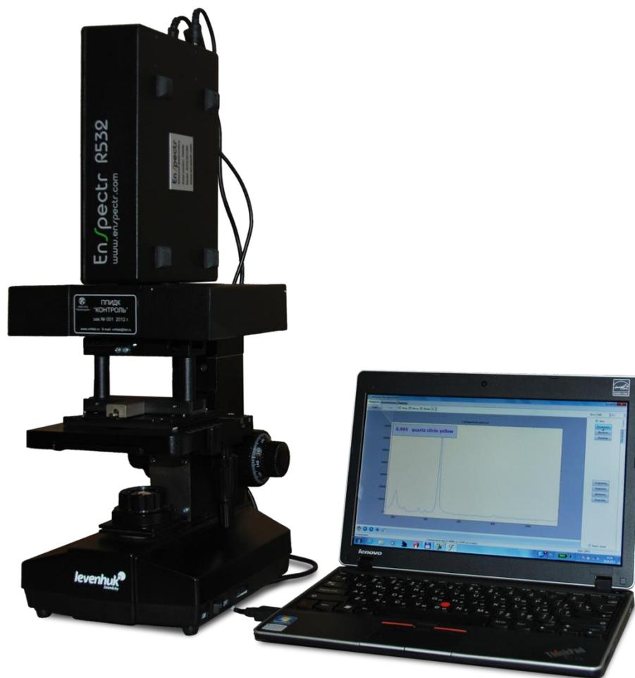
Портативный прибор идентификации драгоценных камней (ППИДК) «Контроль» — специализированный рамановский спектрометр, предназначенный для оперативной диагностики (идентификации) драгоценных камней, их синтетических аналогов и имитаций, а также для автоматического определения их принадлежности к конкретной подсубпозиции (субпозиции, позиции, группе) ТН ВЭД ТС.
